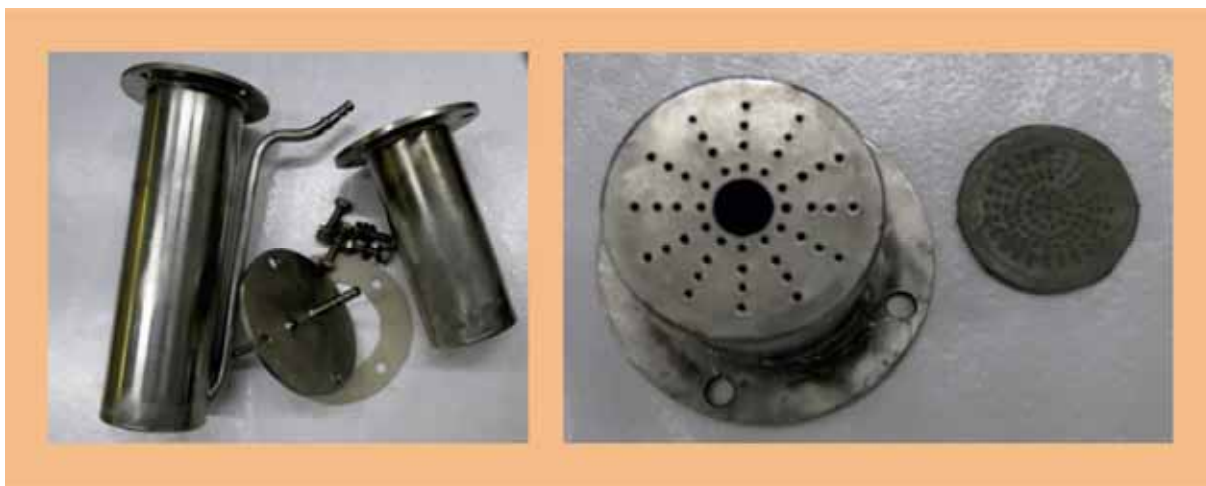
Рис. 3.15. Внешний вид лабораторного аппарата фильтрации (а) и фильтрующей вставки (б) перед сборкой
