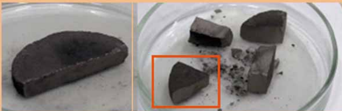
Рис. 3.12. Внешний вид таблетки нитрида урана производства Сибирского химического комбината и её фрагмент для эксперимента
