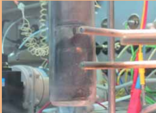
Рис. 3.1. Вид кварцевой ячейки после мягкого хлорирования
