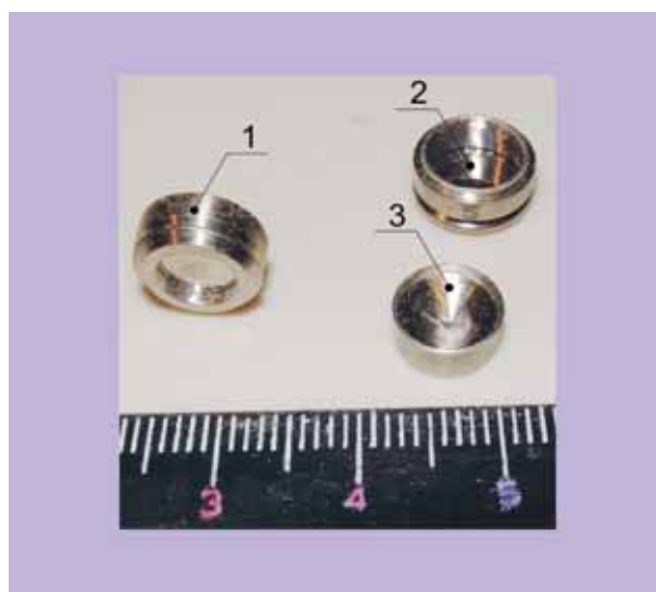
Рис. 4.6. Внешний вид закрытого источника альфа-излучения: 1 — корпус; 2 — выходное окно (титановая фольга толщиной 3 мкм); 3 — пробка
