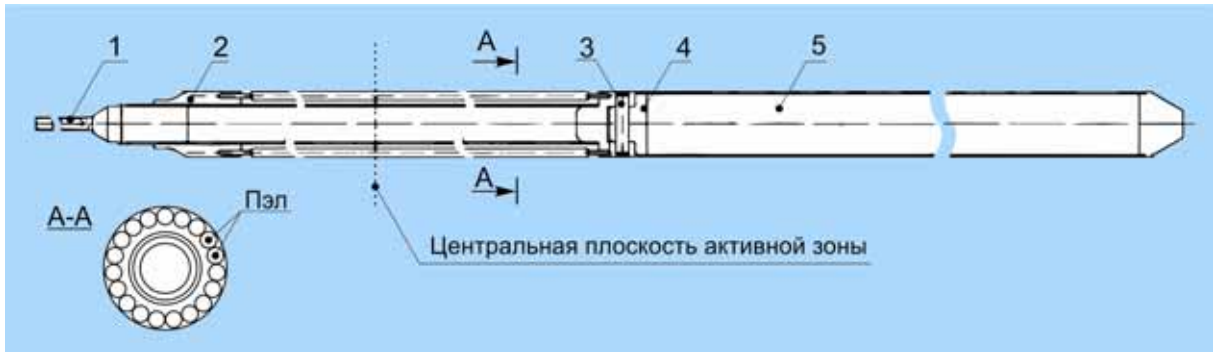
Рис. 1.43. Эскиз и поперечное сечение модифицированного рабочего органа аварийной защиты реактора СМ: 1 — штанга; 2 — поглотитель; 3 — штифт; 4 — хвостовик; 5 — бериллиевая засыпка
