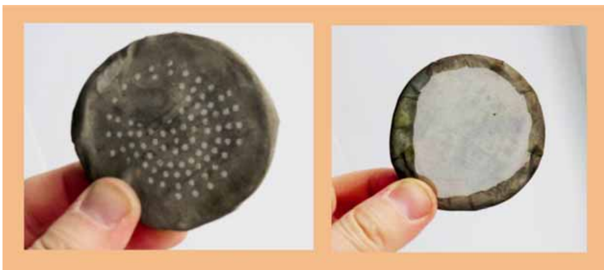
Рис. 3.19. Внешний вид (а, б) фильтра из нержавеющей сетки после отделения от него слитка остаточного кадмия с оксидами
