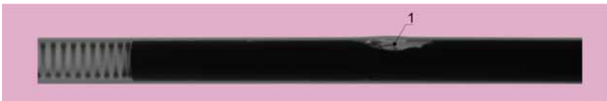
Рис. 2.8. Рентгенографическое изображение негерметичного твэга 163 в месте дефекта (1)
