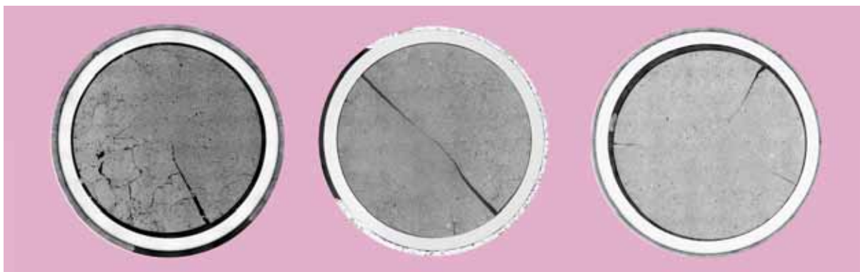
Рис. 2.24. Типичная макроструктура поперечных сечений твэлов со СНУП-топливом: а, б, в — низ, центр и верх топливного сердечника соответственно
