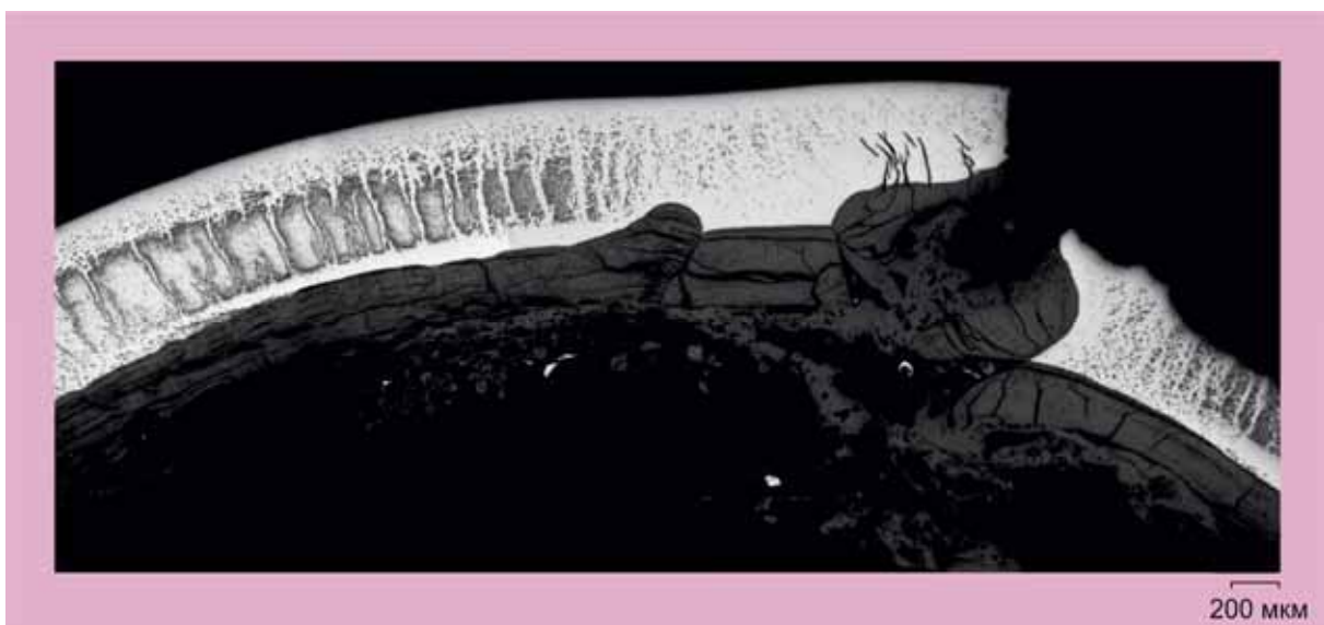
Рис. 2.19. Микроструктура оболочки на участке разрушения твэла
