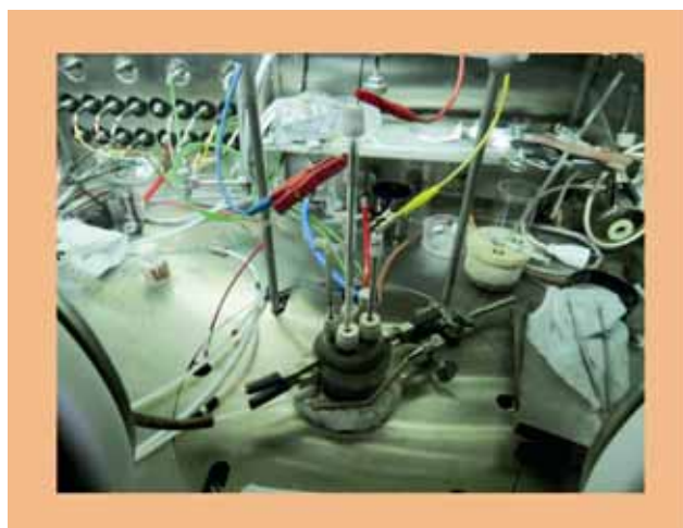
Рис. 3.4. Внешний вид электрохимической ячейки в сборе в инертном боксе
