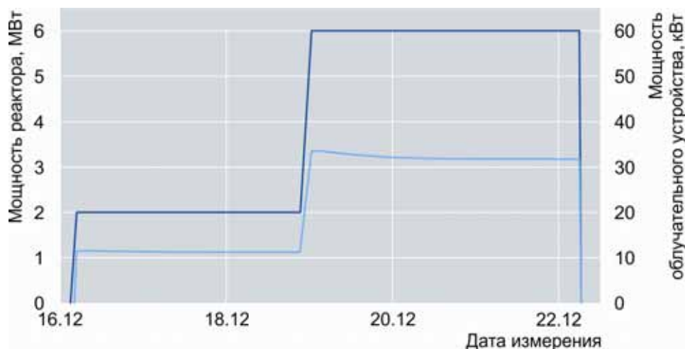
Рис. 1.27. Изменение мощности реактора (—) и облучательного устройства (—) во время испытания мишени
