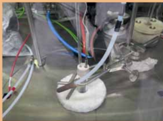
Рис. 3.11. Внешний вид кварцевой пробирки с газоподающей трубкой
