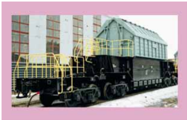
Рис. 2.1. Внешний вид железнодорожного транспортёра для перевозки облучённых тепловыделяющих сборок реактора ВВЭР-1000
