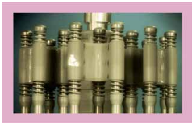
Рис. 2.2. Внешний вид головки поглощающего стержня системы управления и защиты
