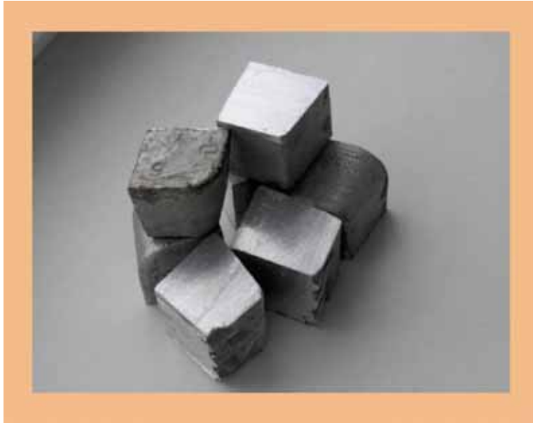
Рис. 3.16. Внешний вид кусков исходного кадмия с оксидными плёнками толщиной более 0,5 мм
