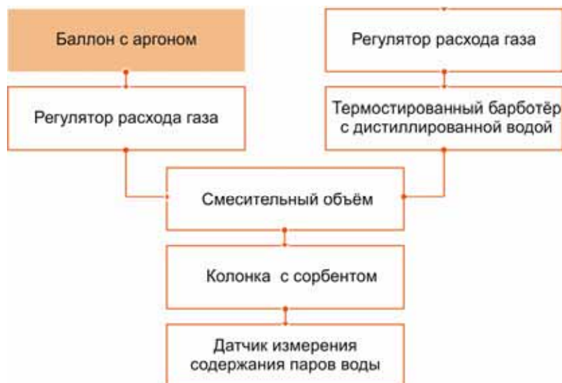
Рис. 3.22. Схема установки для изучения сорбционных свойств полученных сорбентов по отношению к парам воды
