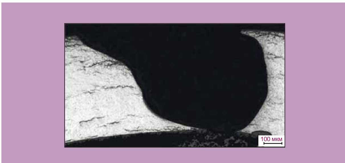
Рис. 2.17. Микроструктура оболочки в районе debris-повреждения
