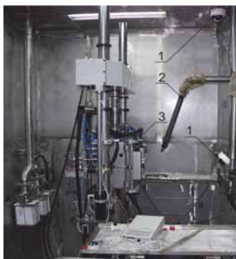
Рис. 2.50. Внешний вид машины для механических испытаний в защитной камере: 1 — видеокамеры; 2 — манипуляторы; 3 — вакуумная печь машины
