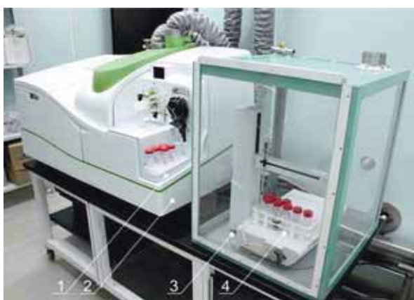
Рис. 2.58. Масс-спектрометрический участок: 1 — масс-спектрометр; 2 — пробирки с пробами и стандартными растворами; 3 — вытяжной бокс; 4 — автосэмплер
