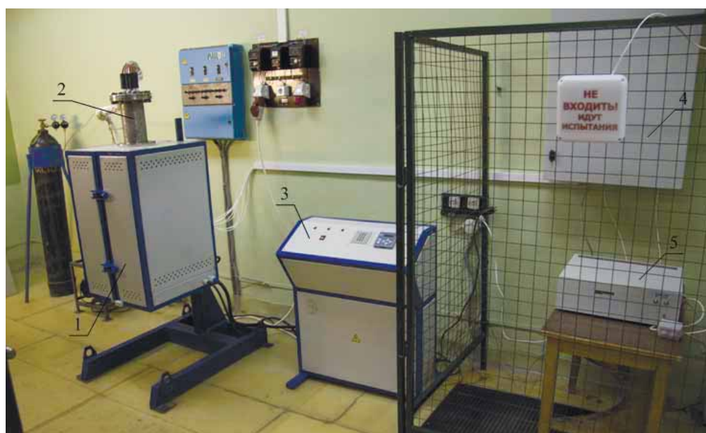
Рис. 1.41. Внешний вид лабораторной установки для термических испытаний: 1 — трубчатая разъемная электропечь с вертикальной рабочей зоной нагрева; 2 — модель канального облучательного устройства; 3 — программируемый пульт управления электропечи; 4 — шкаф высоковольтный; 5 — аппарат испытания диэлектрических материалов
