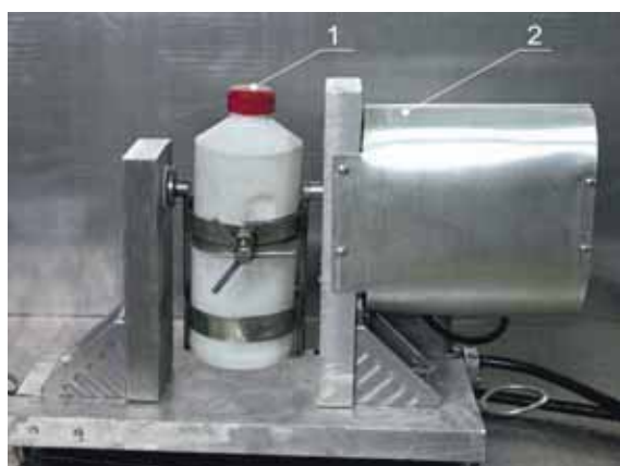
Рис. 2.57. Устройство для разбавления проб: 1 — держатель ёмкости с пробой; 2 — двигатель
