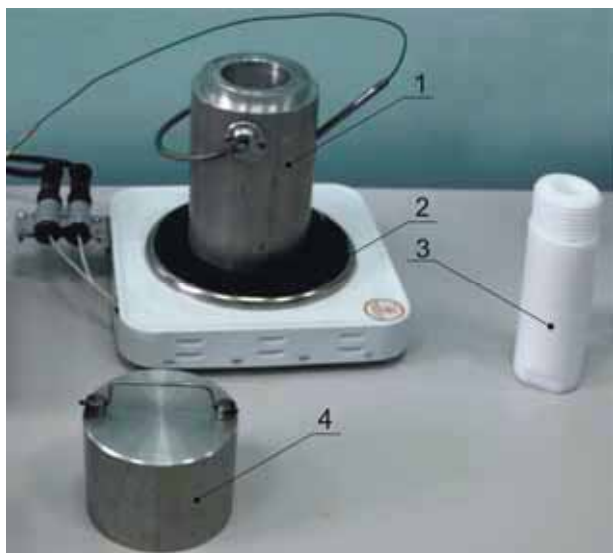
Рис. 2.55. Термостат для растворения образца: 1 — термостат; 2 — автоклав; 3 — электропечь, 4 — крышка термостата
