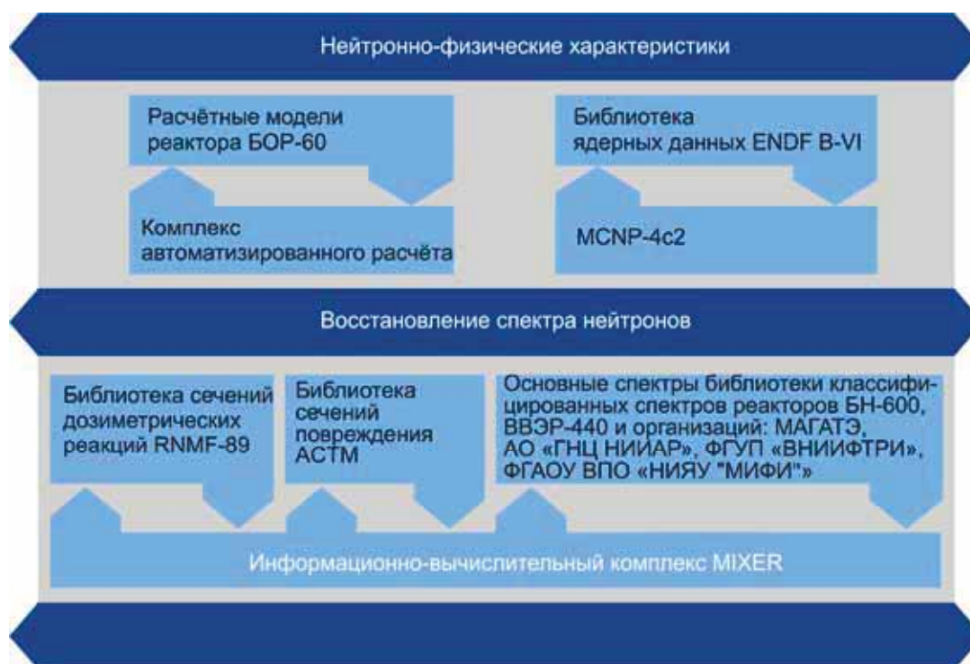
Рис. 1.46. Схема программного обеспечения для расчёта нейтронно-физических характеристик
